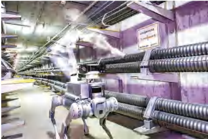
图 3.11: 电缆隧道机器狗巡检作业示意 [1]
